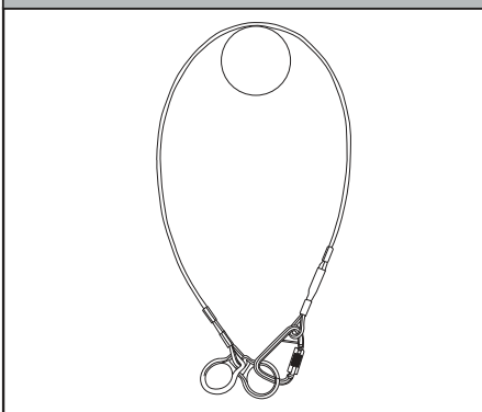
Figure 14 - Installation de l'ancre d'étranglement
