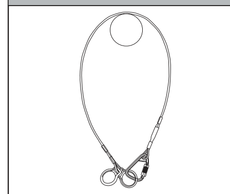
Figure 14 - Installation de l'ancre d'étranglement
