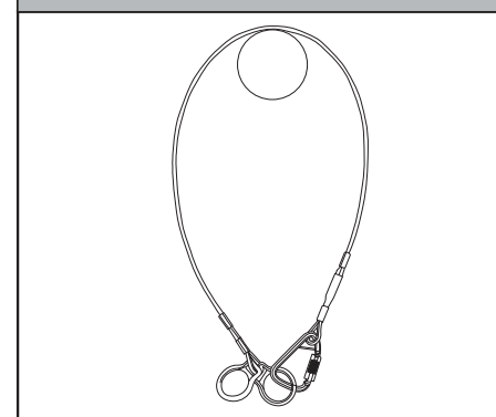
Figure 14 - Installation de l'ancre d'étranglement
