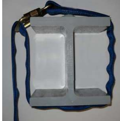
Conexión incorrecta del amarre
