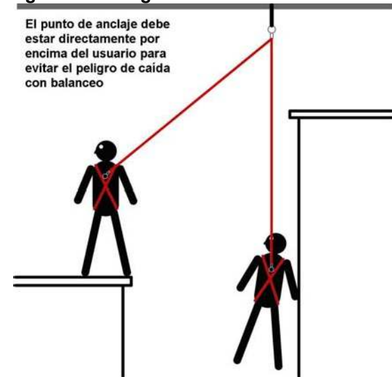
Figura 2.2: Diagrama de caída con balanceo
